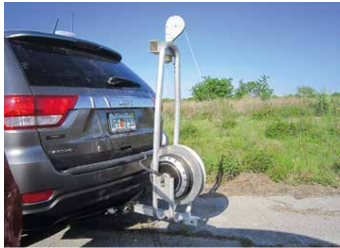
Den stora eWinchen med abroll-funktion.
