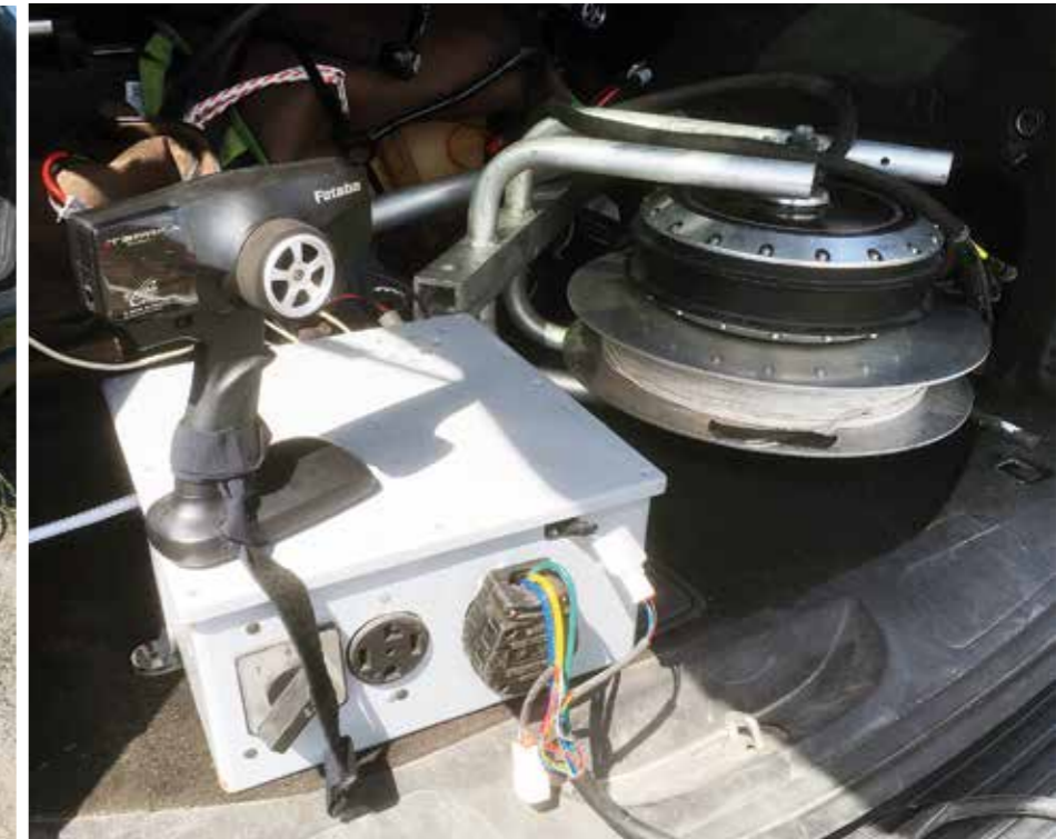
Mitten tv: Vi missade att sätta i sprinten så vinschen slets loss under draget.
