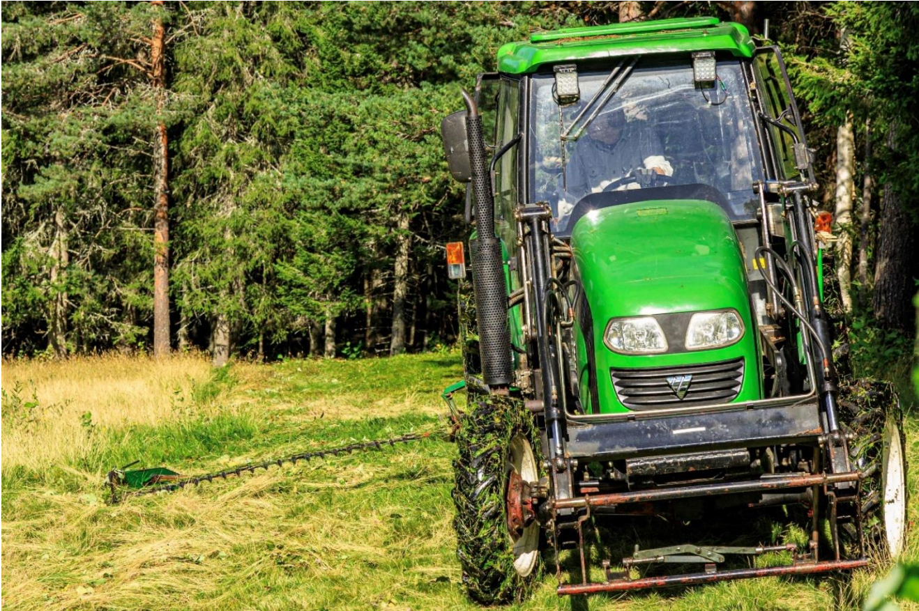
Bild 3. Slätteraggregat med skärande tänder (åtgärd 1).
